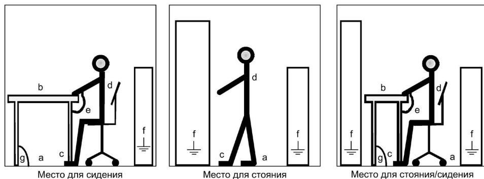
Рисунок 1-1 Меры по защ. эл-тов, подверж. опасн. разруш. в рез. эл. стат. разряда
