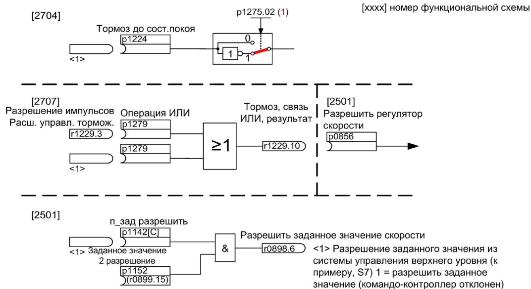
Рисунок 9-20 Пример рабочего тормоза привода крана
