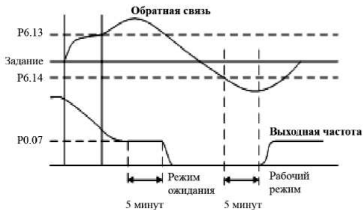
Рисунок 6-25: функции ожидания и выхода из режима ожидания.
