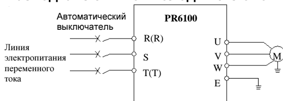
Рисунок 3-3. Упрощённая разводка колодки силовой схемы
