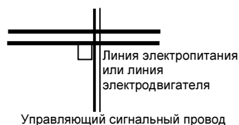
Рисунок 3-14. Требования к прокладке проводов
