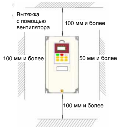
Рисунок 3-1. Пространство, требуемое для установки преобразователя
