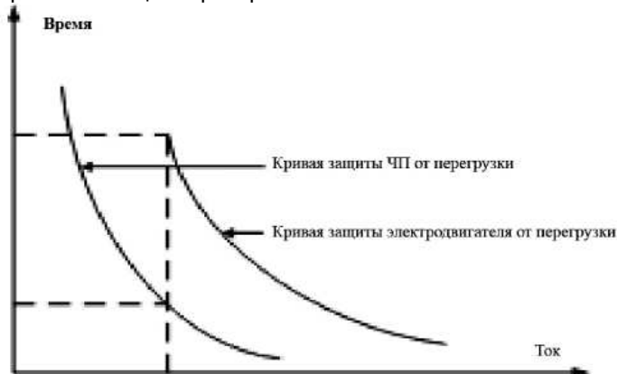
Рисунок 6-30: кривая защиты мотора и инвертора от перегрузок
