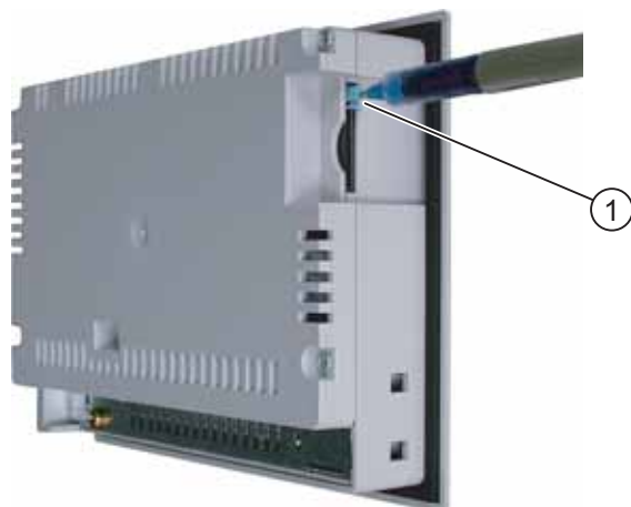
Рисунок 5-4 Извлечение карты памяти на примере TP 177B
