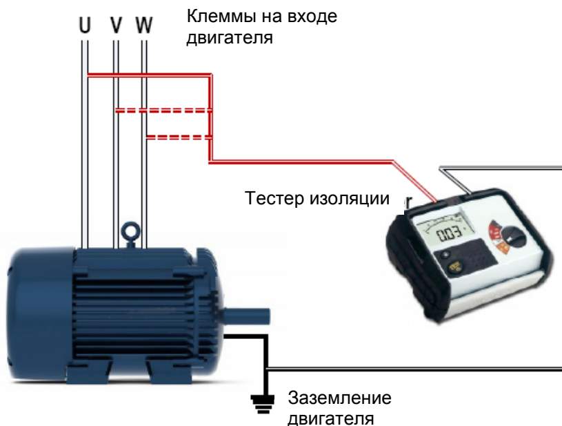
Рис. 1-1. Соединения, требуемые для проверки изоляции двигателя.
