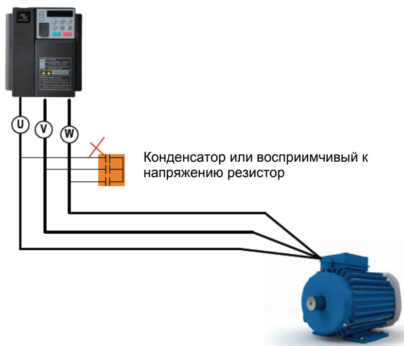
Рис. 1-2. Недопустимые подключения к выходу привода переменного тока
