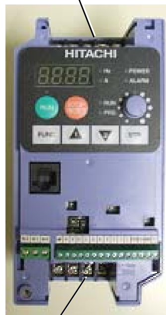
Клеммная колодка подключения электродвигателя и дополнительных устройств (дроссель звена постоянного тока, тормозное устройство)
