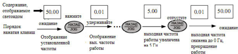
Рис. 4-9 Пример функционирования толчковой работы
