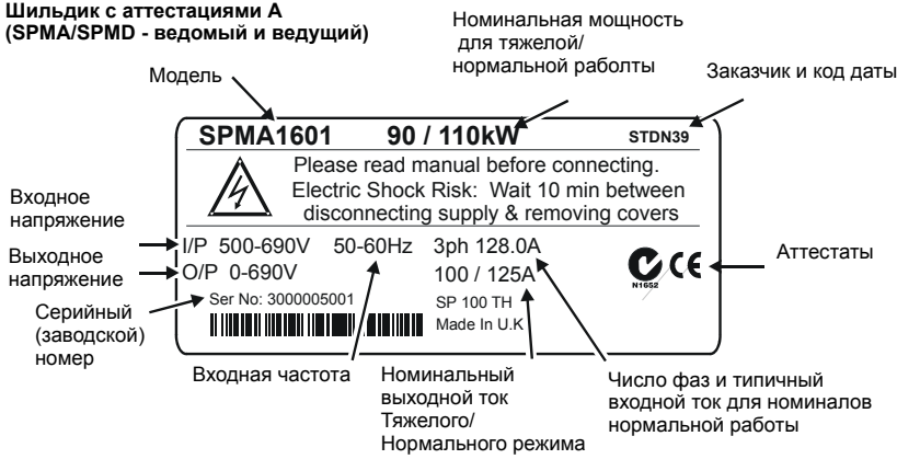
Рис. 3-2 Типичные шильдики с паспортными данными привода
