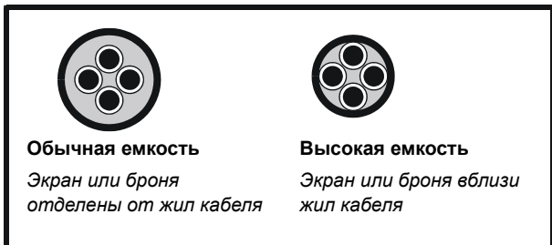
Рис. 6-10 Конструкция кабеля влияет на его емкость
