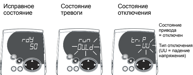
Рис. 15-2 Расположение светодиода состояния
