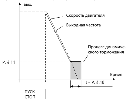
Рис. 9.12: Время торможения постоянным током в режиме останова с линейным замедлением
