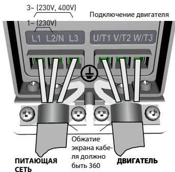
Рис. 3.17: Подключение силовых кабелей преобразователя Vacon 20, MI1
