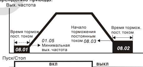
Торможение постоянным током
