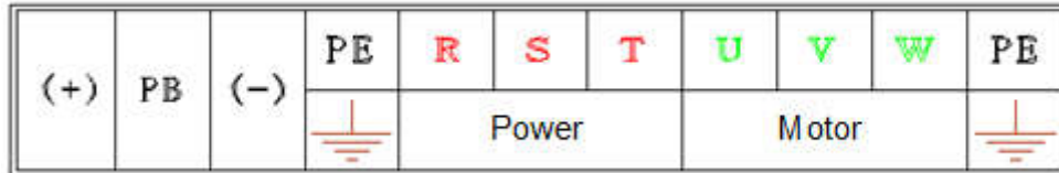
Схема расположения клемм на ПЧ 11...22 кВт
