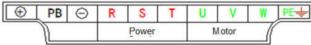
Схема расположения клемм на ПЧ 5,5...15 кВт 380 В
