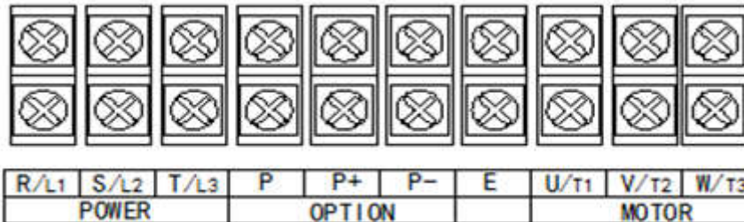
Схема расположения клемм на ПЧ 22...110 кВт
