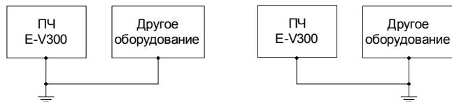
в) Плохой способ заземления
