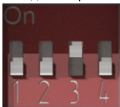
Рисунок 9.64 – DIP-переключатель. Джампер 3 в положении ON
