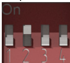
Рисунок 6.4 – DIP-переключатель. Джампер 2 в положении ON
