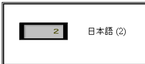
Рисунок 9.26 – Мультиязычный проект в режиме эмуляции (PFW101 = 2)
