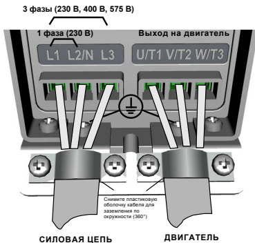
Рис. 3.7: Подключение силовых кабелей преобразователя Vacon 10, MI1
