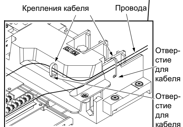
Рисунок 2-3-13 Расположение креплений проводов цепи управления преобразователя частоты.
