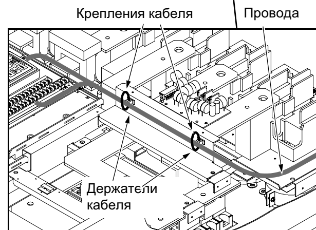
Рисунок 2-3-17 Места закрепления кабелей
