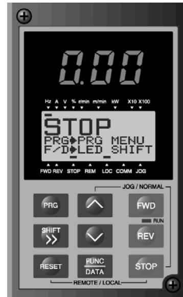
Рисунок 3-1-2 Дисплей на панели пульта оператора при включенном питании.
