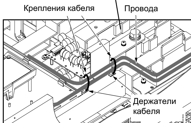
Рисунок 2-3-15 Места закрепления кабелей
