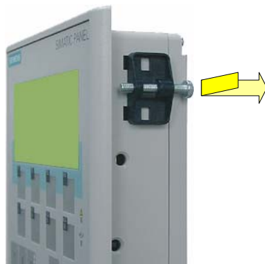
Рисунок 4-11 Установка винтовых зажимов на устройстве НМІ
