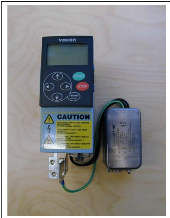
Рис. 6-13. MF2 с фильтром радиопомех типа RFI-filter RFI-0012-2-1
