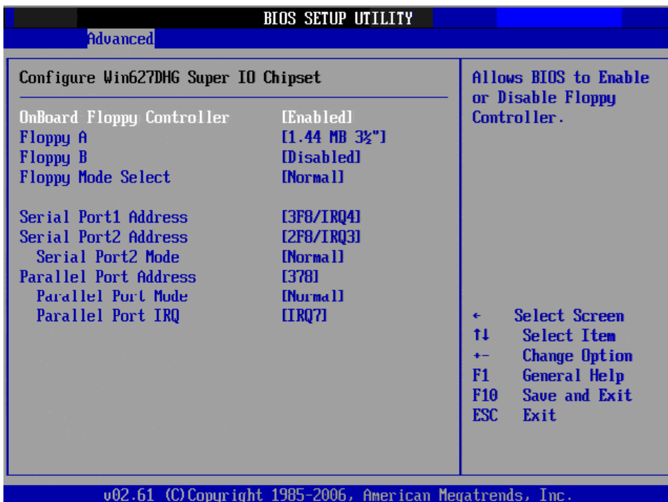
Рисунок Б.5 – подменю Super IO Chipset
