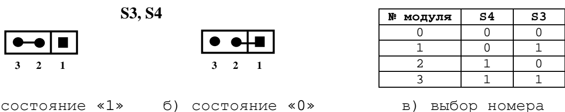
Рисунок 8.3 – Положение переключателей при выборе номера модуля RCDA NC110-35
