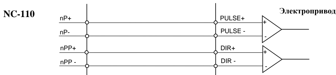
Рисунок 9.14 – Подключение дифференциальных сигналов ЦИП
