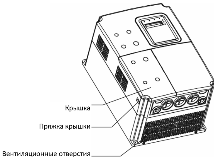
Рисунок 1.2. Компоненты инверторов (15 кВт и меньше)
