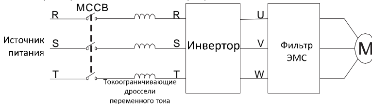
Рисунок 4.17. Электромонтаж силовой цепи электродвигателя
