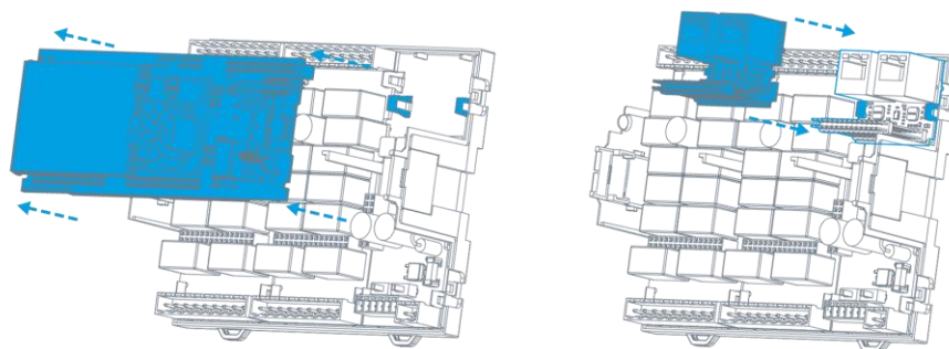
Рис. 67 – Снятие процессорной платы и установка платы сетевого модуля
