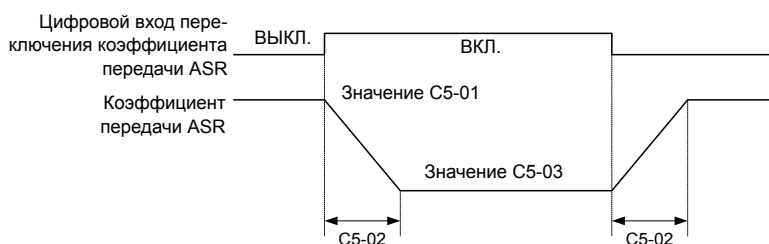
Рис. 6.44 Переключение коэффициента передачи ASR с помощью дискретного входа
