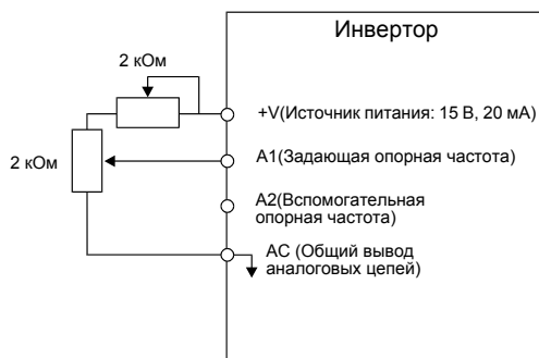
Рис. 6.6 Подача задающей опорной частоты
