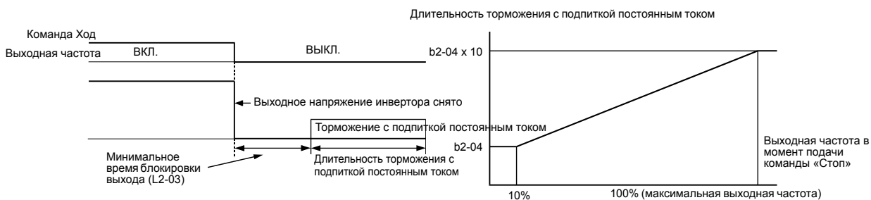
Рис. 6.18 Торможение с подпиткой постоянным током до остановки
