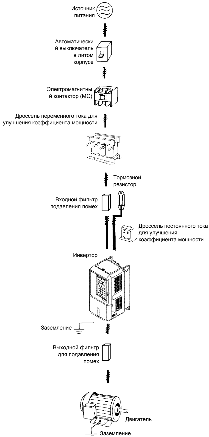
Рис. 2.1 Пример подключения периферийного оборудования
