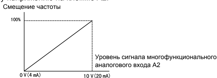
Рис. 6.32 Регулировка смещения частоты (с помощью входа А2)
