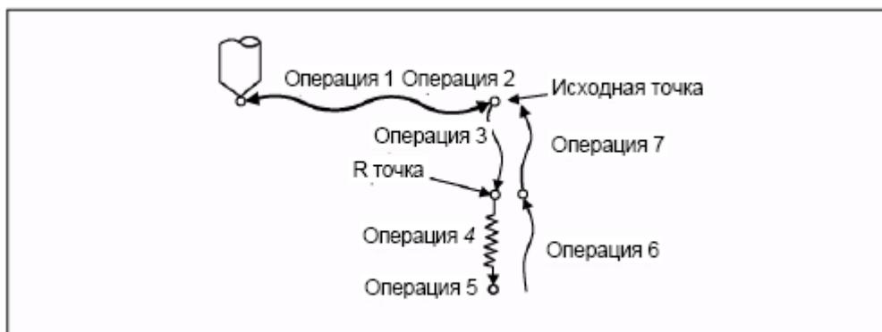
Операция 3: Инструмент позиционируется в точку R на быстром ходу.
