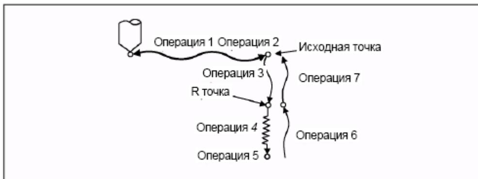
Операция 1 :позиционирование (на быстром ходу) инструмента в исходную точку по координатам X (Z) и C. Если задана " I " (Позиционирование с заданной точностью), контроль заданной позиции будет выполняться после завершения кадра.
