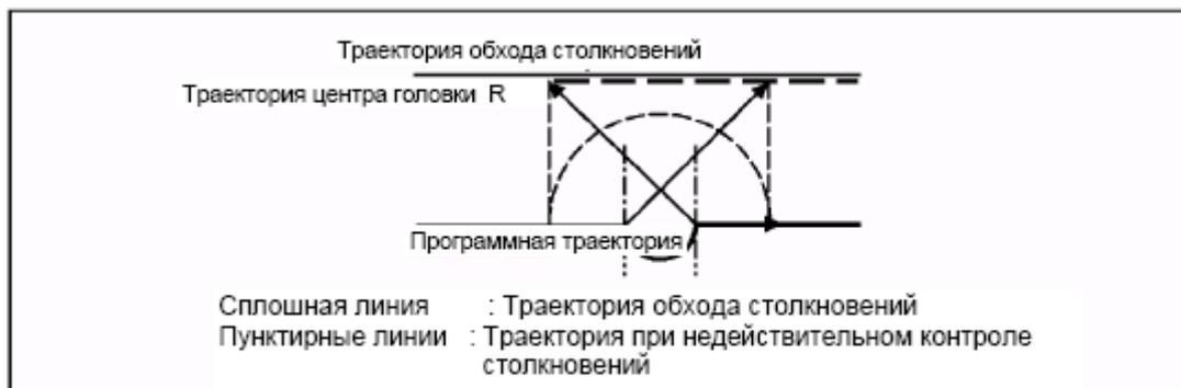
На рисунке внизу резец движется в противоположном направлении при N2. После выполнения N1, выводится сообщение об ошибке программирования (P153).
