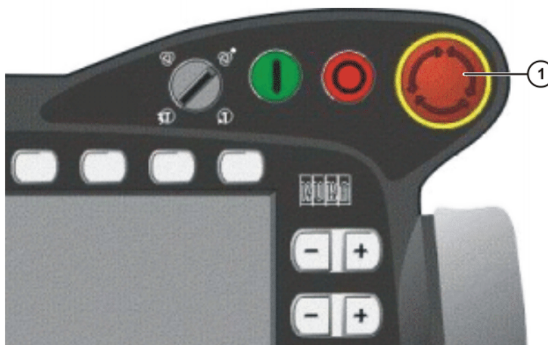
Рис. 5-3: Кнопка аварийного останова на КСР
